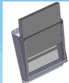
**CONSEILS D'ENTRETIEN:** Le curage de la partie décantation doit être effectué une fois par semestre minimum. Le filtre est sorti pour être nettoyé régulièrement par un simple jet d'eau pour maintenir la capacité de filtration. Le filtre doit être changé tous les ans.
