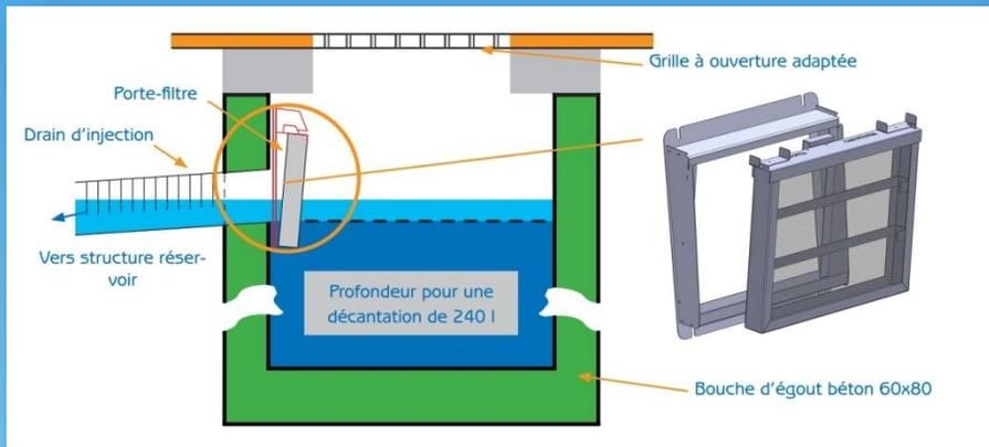
**DIMENSIONNEMENT:** Une bouche d'injection reprend les eaux pluviales de 200 à 250 m<sup>2</sup> de voirie (chaussée - trottoir). Il ne réduit donc pas la capacité d'absorption de la bouche en cas d'orage décennal (15L/s)
